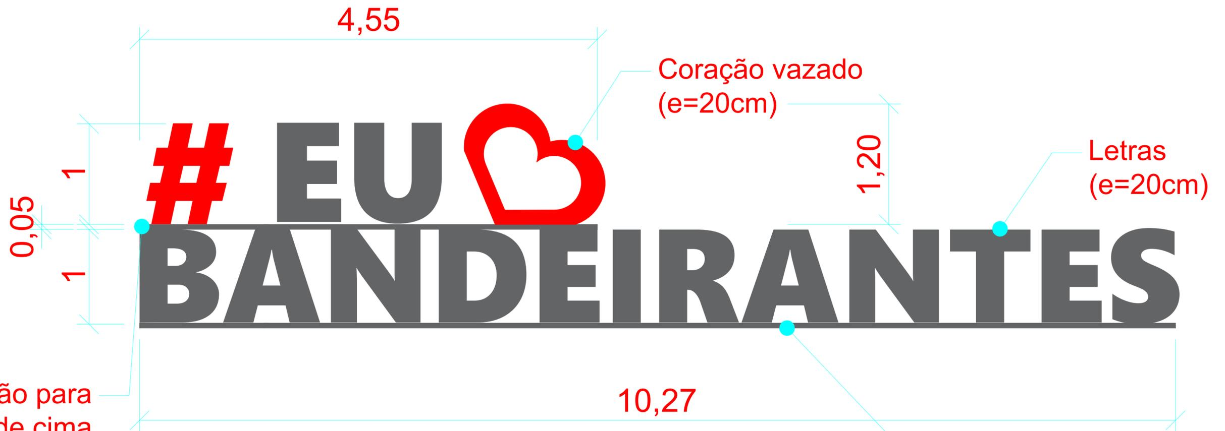
Viga de fixação para as letras de cima (4,55x0,05x0,20m) Perfil U, duplo e espelhado.
